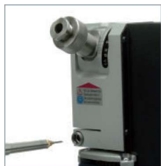
Réglage précis de la longueur de l'électrode.
